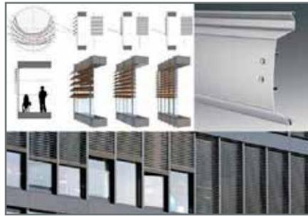
La structure de béton sera entièrement capotée d'un habillage métallique isolé dans lequel seront insérés les coffres et rails des stores brise-soleil.
